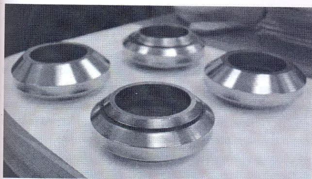
Рис. 5. Комплект валков турголовок ТЭСА 10-25
